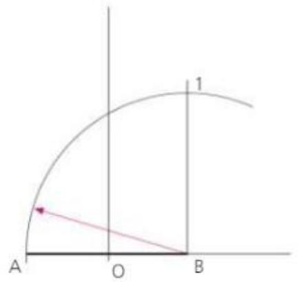
**2:** con apertura **AB** punto in **B** traccio l'arco e trovo **1** intercettando la perpendicolare di B.
