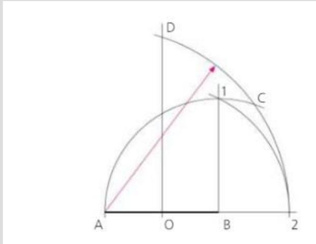
**4**: punto in A con apertura **A2** traccio l'arco che incontra la perpendicolare ad AB nel punto **D**. Nel passaggio incontro anche l'arco iniziale, di raggio AB, trovando il punto **C**.
