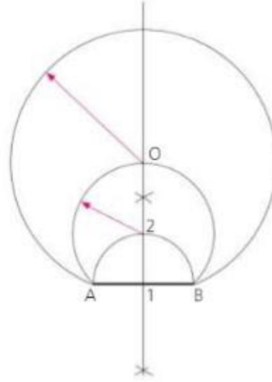
**2:** punto in 2 con apertura 2° traccio l'arco da A a B. Incontro il punto O sulla perpendicolare. Punto in O con apertura O2, traccio l'arco da A a B.
