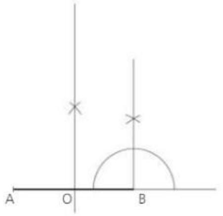
**1:** traccio il segmento **AB**, di 3cm, orizzontale. Con apertura AB punto in A e poi in B e trovo la perpendicolare ad AB passante per il centro **O**. Prolungo AB e trovo la perpendicolare uscente da B
