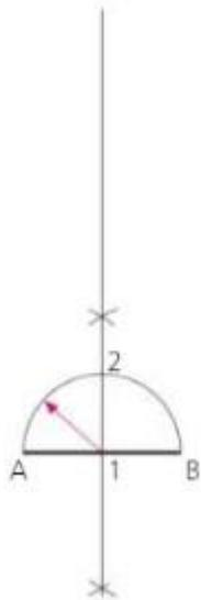
**1:** traccio il segmento orizzontale AB di 2 cm, orizzontale, e con apertura AB punto in A e poi in B, ottengo la perpendicolare passante per 1 (centro). Punto in 1 e traccio l'arco AB.
