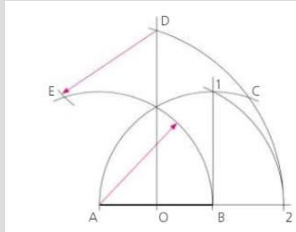
**5**: punto in **A** con apertura **AB** e traccio l'arco che, intersecato con quello ottenuto puntando in **D**, sempre apertura **AB**, da origine al punto **E**
